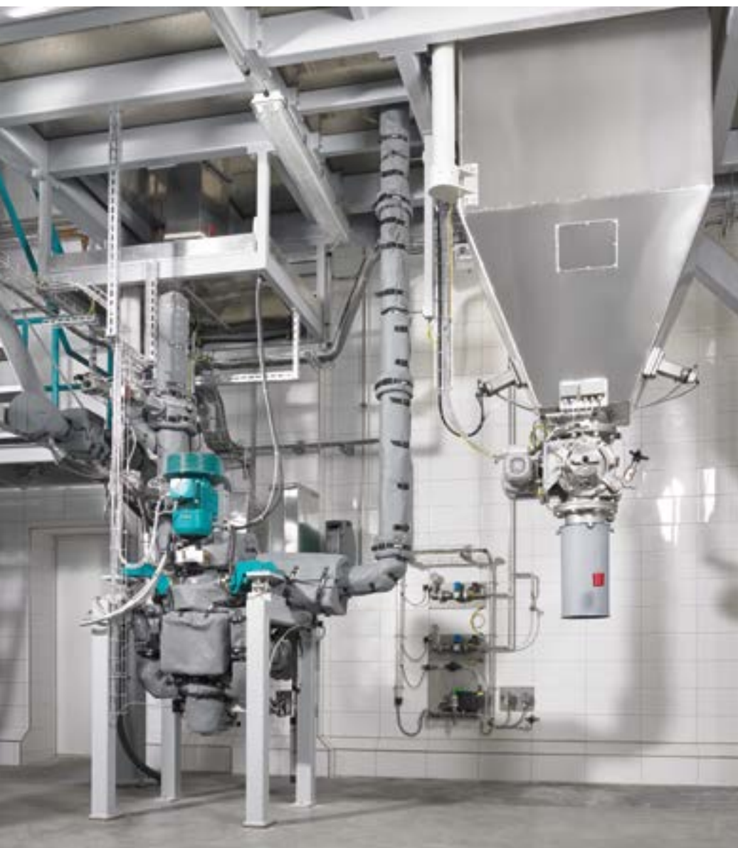
Пароструйная мельница s-Jet®150 в лаборатории компании NETZSCH
