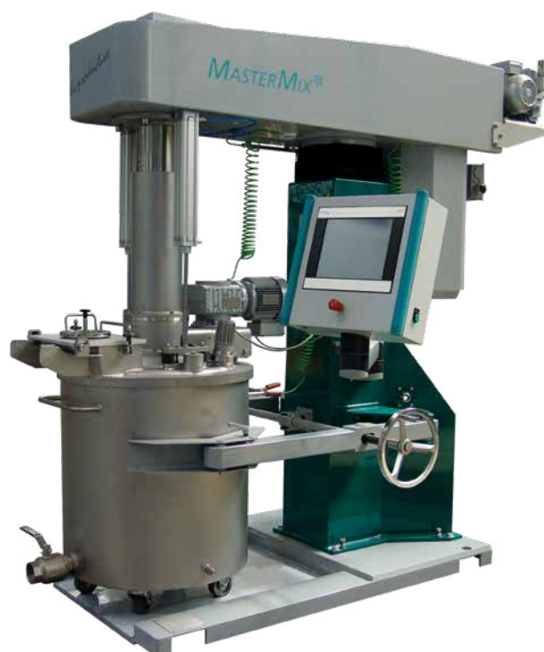
Диссольтвер MASTERMix® 37 с вакуумной крышкой, скребком для стенок ёмкости, весовой платформой и ПЛК
