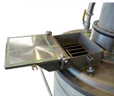
Вакуумная крышка с откидывающейся секцией для загрузки из мешков
