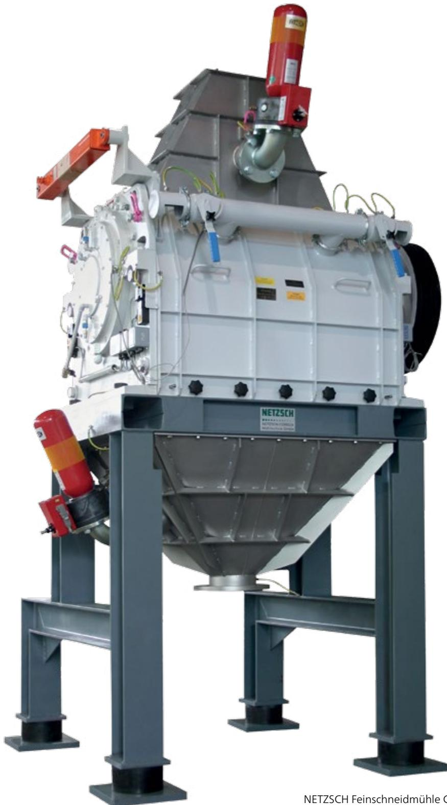
Die NETZSCH Feinschneidmühlen der Typenreihe CS-Z sind schnelllaufende Schneidmühlen mit hoher Schnittfolge zur Grob- und Feinvermahlung schnittfähiger Stoffe. Anwendungsbereiche sind Materialien, die durch schneidende Zerkleinerung feingemahlen werden müssen, z.B. temperaturempfindliche Stoffe, sowie Materialien, bei denen gute Rieselfähigkeit, hohes Schüttgewicht und schonende Vermahlung gefordert wird.
