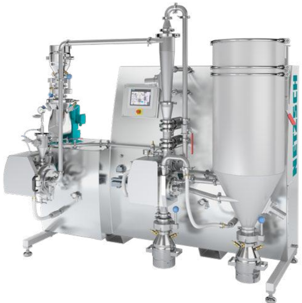
NETZSCH con mulino a getto a letto denso e classificatore fine ad alte prestazioni
