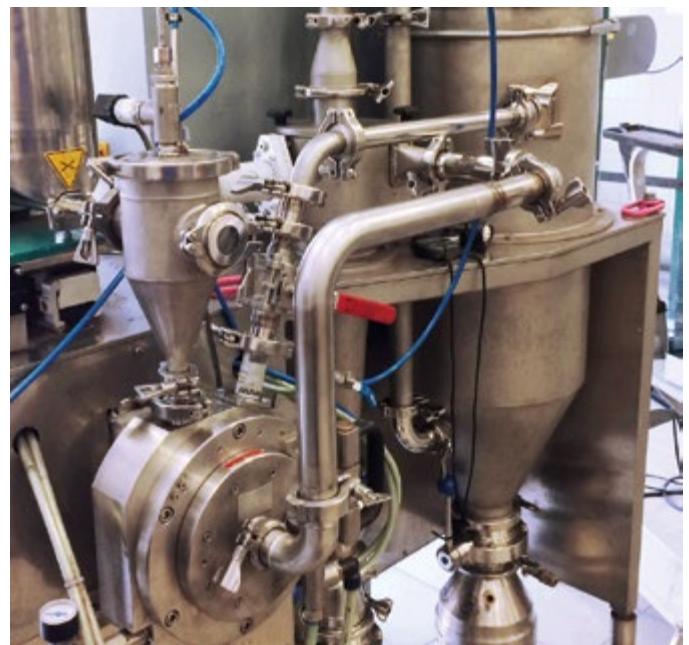
Laboranlage 10 mit Ausschleusleitung in das Staubfilter
