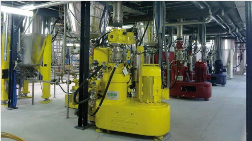
Anlage zur Herstellung von Verpackungsdruckfarben auf NC- oder PU-Basis
