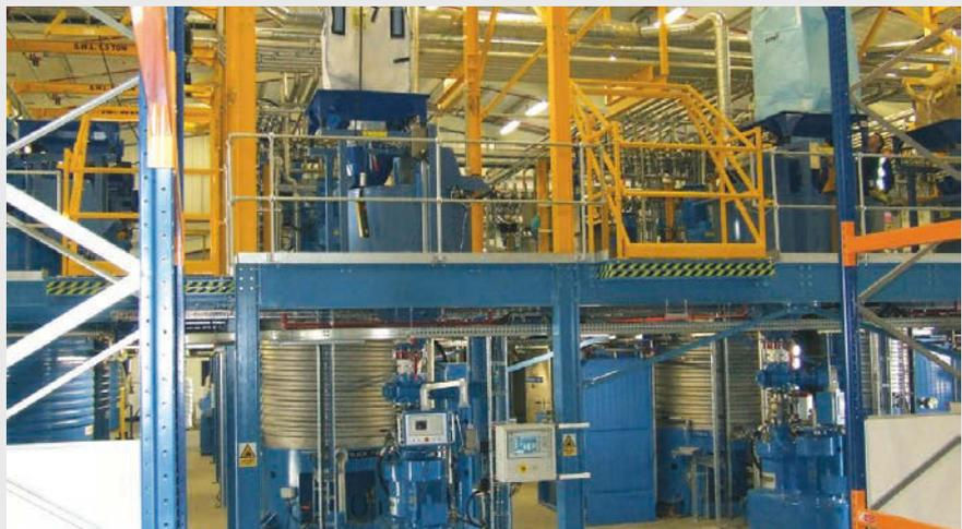
Anlage zur Herstellung von Rotationstiefdruckfarben
