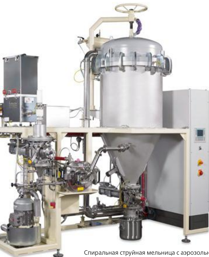
Измельчение лактозы на сепарационной мельнице CSM 360
