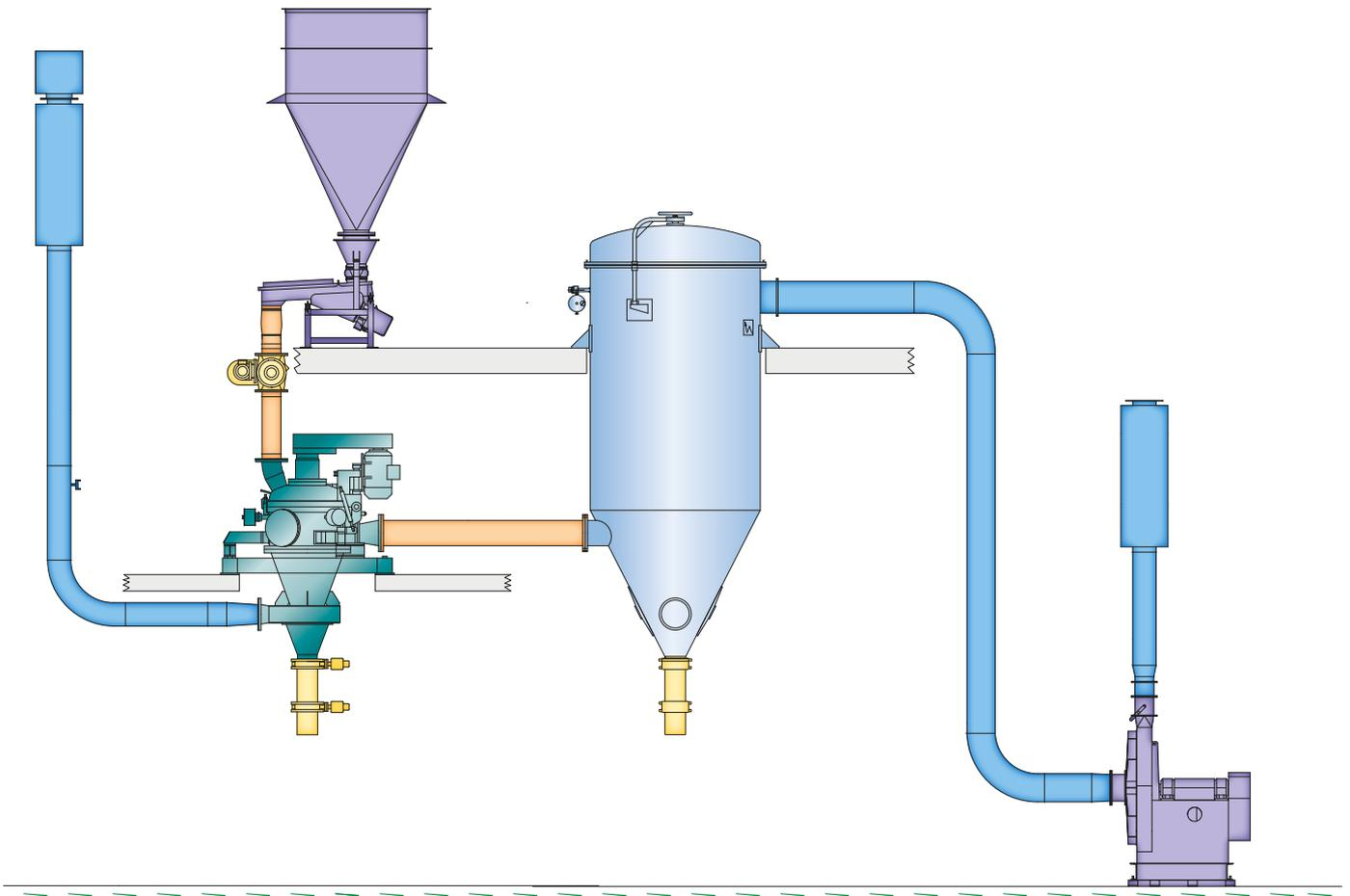
Komplette Sichtanlage mit NETZSCH Feinstsichter CF5
