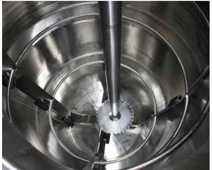
Innenansicht eines Intensivmischers mit Ankerrührwerk und Dispergierscheibe
