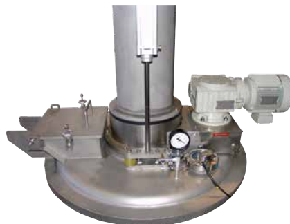
Vakum poklopac spremnika s pogonom
