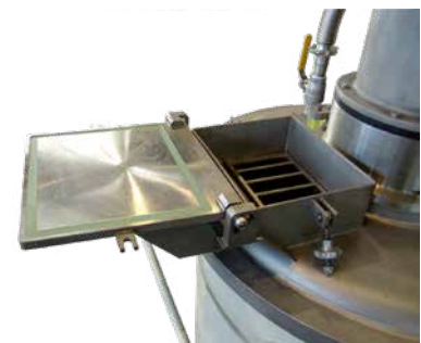
Vakum poklopac s otvora za dozi-ranje sirovina iz velikih vreća
