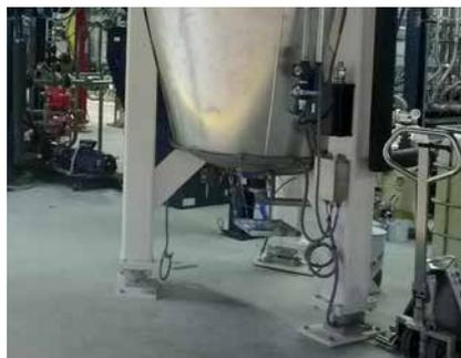
Maschine auf Wägezellensystem
