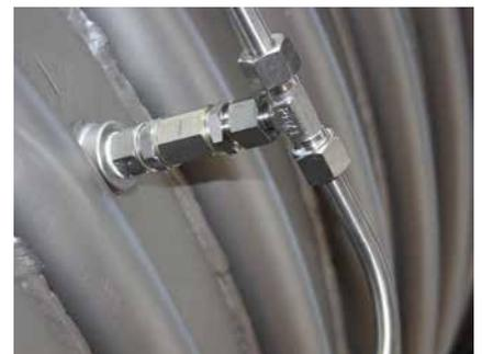
Reinigungsdüsen in der Behälteraußenwand
