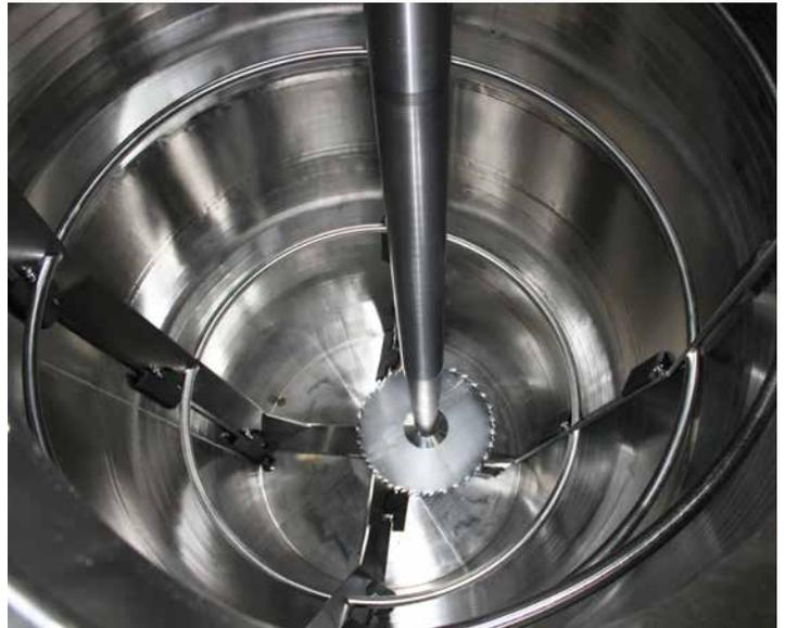
Innenansicht eines Intensivmischers mit Ankerrührwerk und Dispergierscheibe
