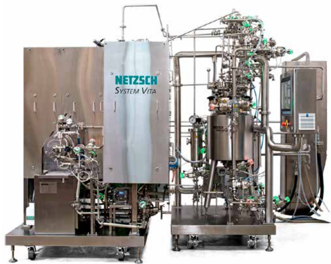
System VITA®, bestehend aus einer Rührwerkskugelmühle DELTAVITA® und einem Ansatzbehälter GAMMAVITA®
