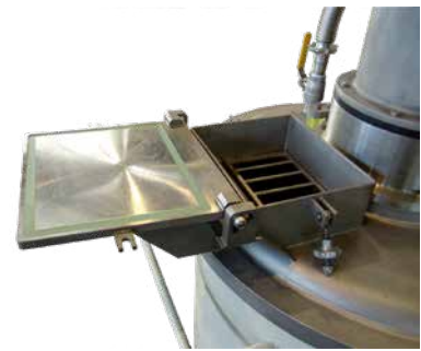
Couvercle sous vide avec trappe de chargement et couvercle pivotant servant au support de sac
