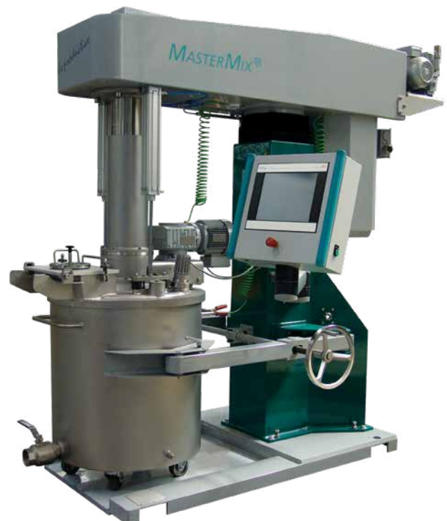
Dissolver MASTERMIX® 37 avec couvercle de cuve sous vide et racleur rotatif
