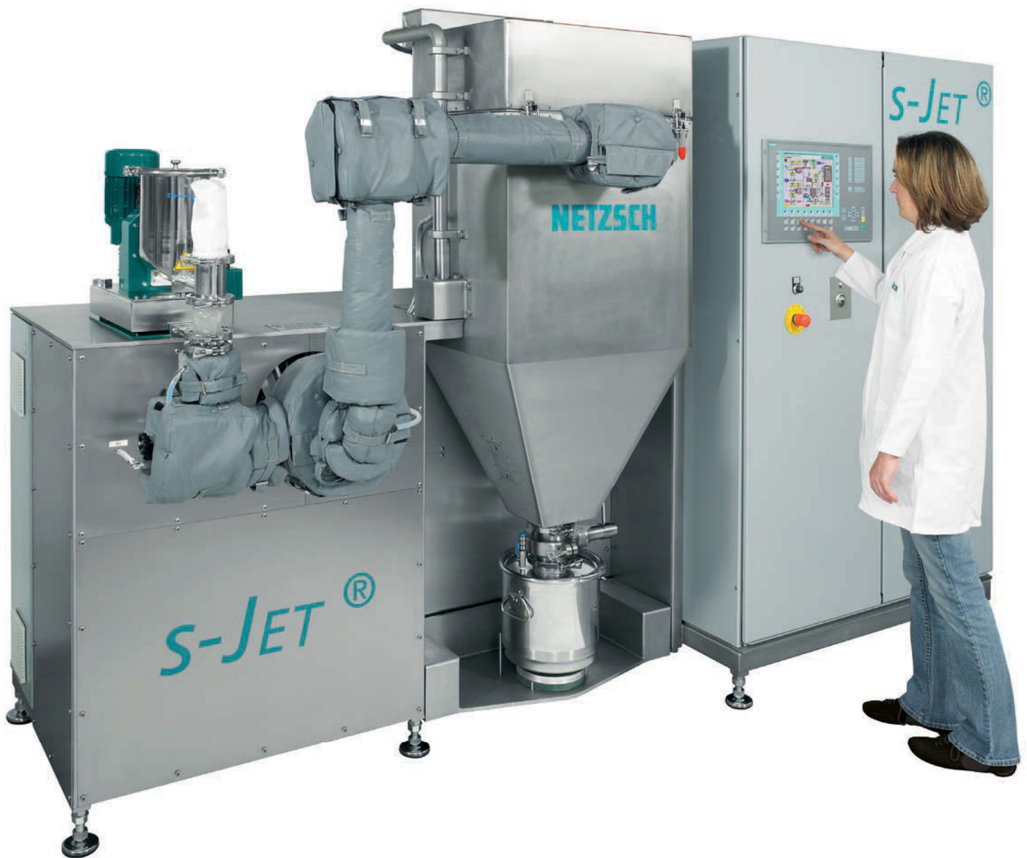
NETZSCH Dampfstrahlmühle s-JET ® 25 – komplette Anlage inklusive Dampferzeugereinheit
