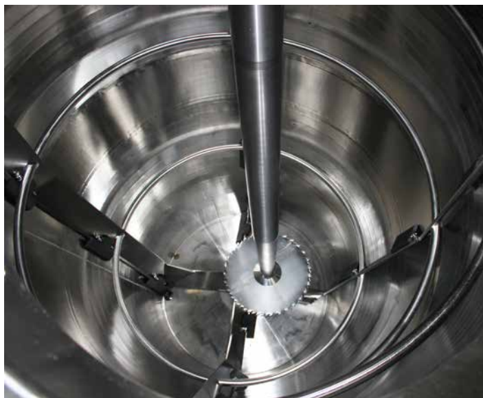
Unutarnji pogled na intenzivni mikser sa sidrenom miješalicom i diskom za dispergiranje
