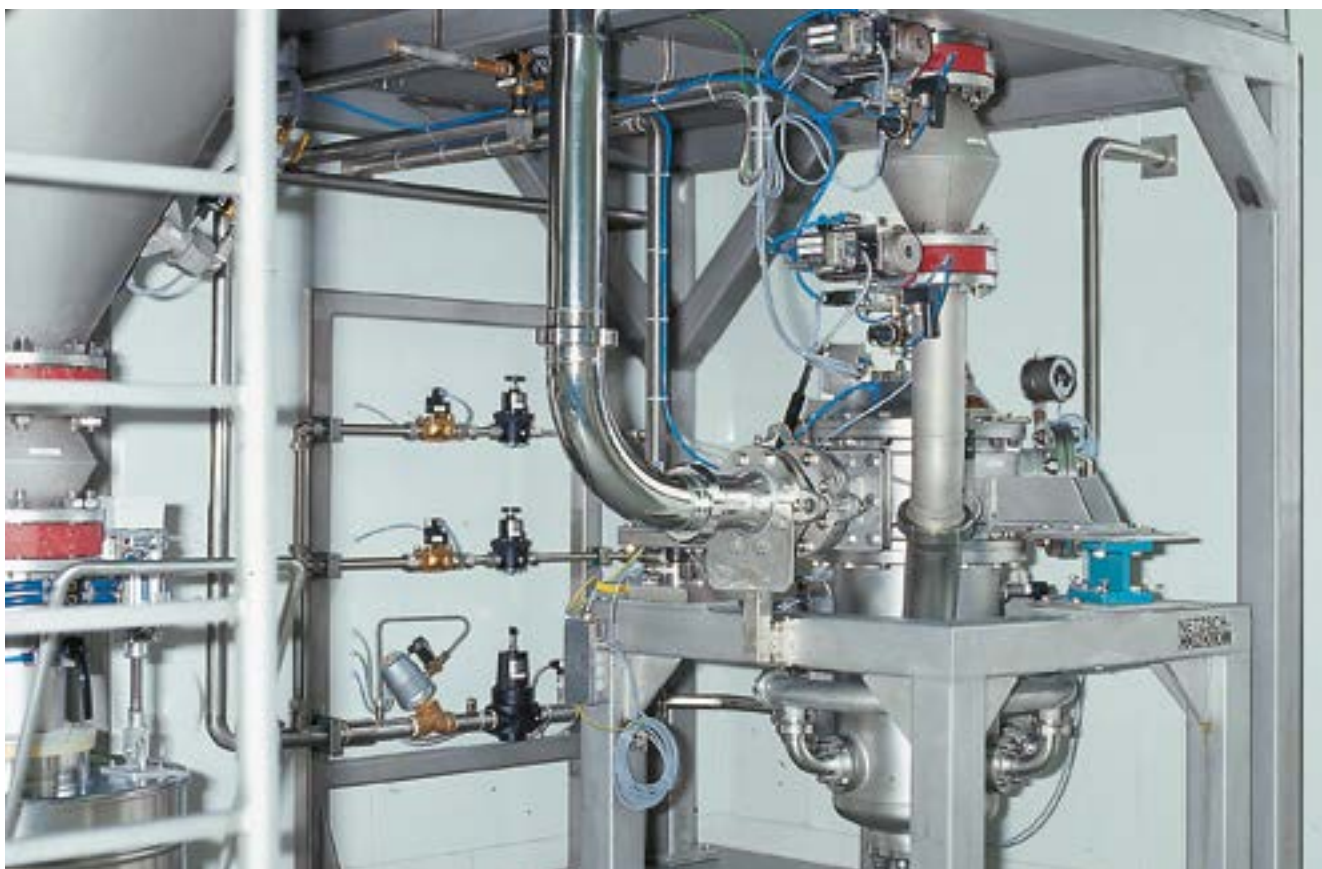
Instalacja z młynem strumieniowo-fluidyzacyjnym CGS 32 w wykonaniu „Pharma design”
