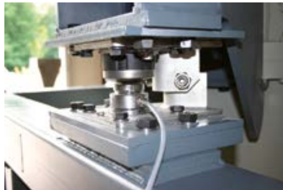
Ogniwo obciążnikowe, zamontowane w młynie CGS
