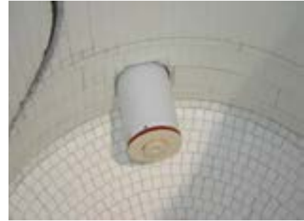
Camera di macinazione con rivestimento ceramico
