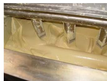
Abbildungen 4 und 5: Trocken- und Nassconchieren mit CHOCO EASY ®
