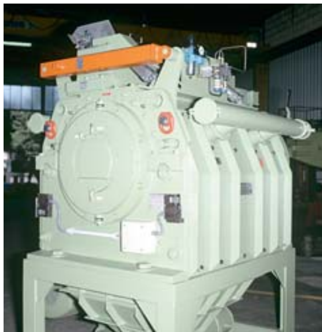
Die Feinschneidmühle CS 500/1000 wurde für das Pulverisieren von Zellstoff entwickelt
