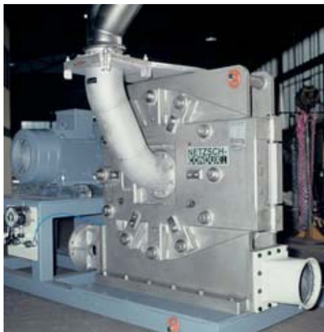
Die Universalismühle CUM 680 lässt sich für die Feinvermahlung von Zellulosederivaten einsetzen
