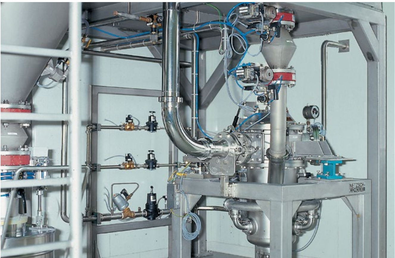
Installation mit Fließbettstrahlmühle CGS 32 in Pharma-Ausführung
