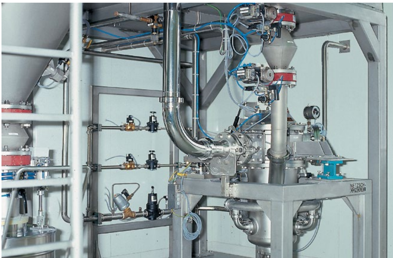
Установка со струйной мельницей CGS-32 в фармацевтическом варианте
