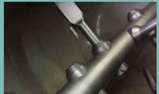
Ansicht der Conche nach 15 Minuten intensiver Reinigung in Zirkulation. 5-8% Fett des Conchen-Netto-Volumens
