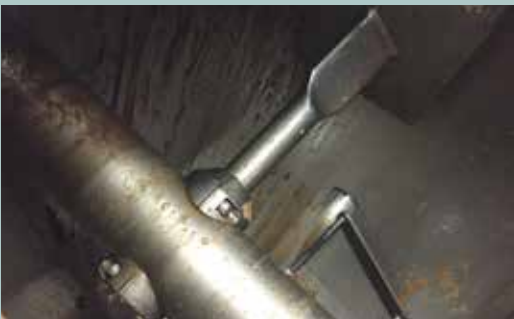
Ansicht der Conche nach 5-10 Minuten einfacher Reinigung ohne Zirkulation, 2-5% Fett des Conchen-Netto-Volumens
