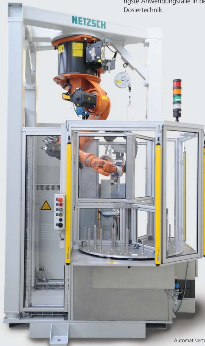
Automatisierte Dosierzelle mit Knickarmroboter
