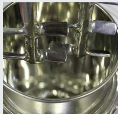
Laborplanetenmischer Typ PML 1 in Vakuumausführung – Einsatz von konventionellen, temperierbaren Weißblechdosen als Ansatzbehälter
