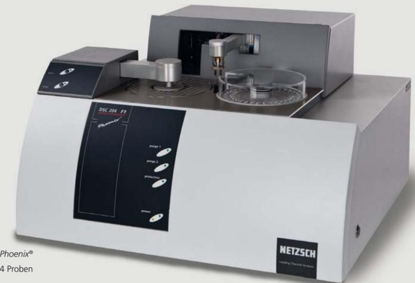
Differenzkalorimeter DSC 204 F1 Phoenix® mit automatischem Probenwechsler für bis zu 64 Proben
