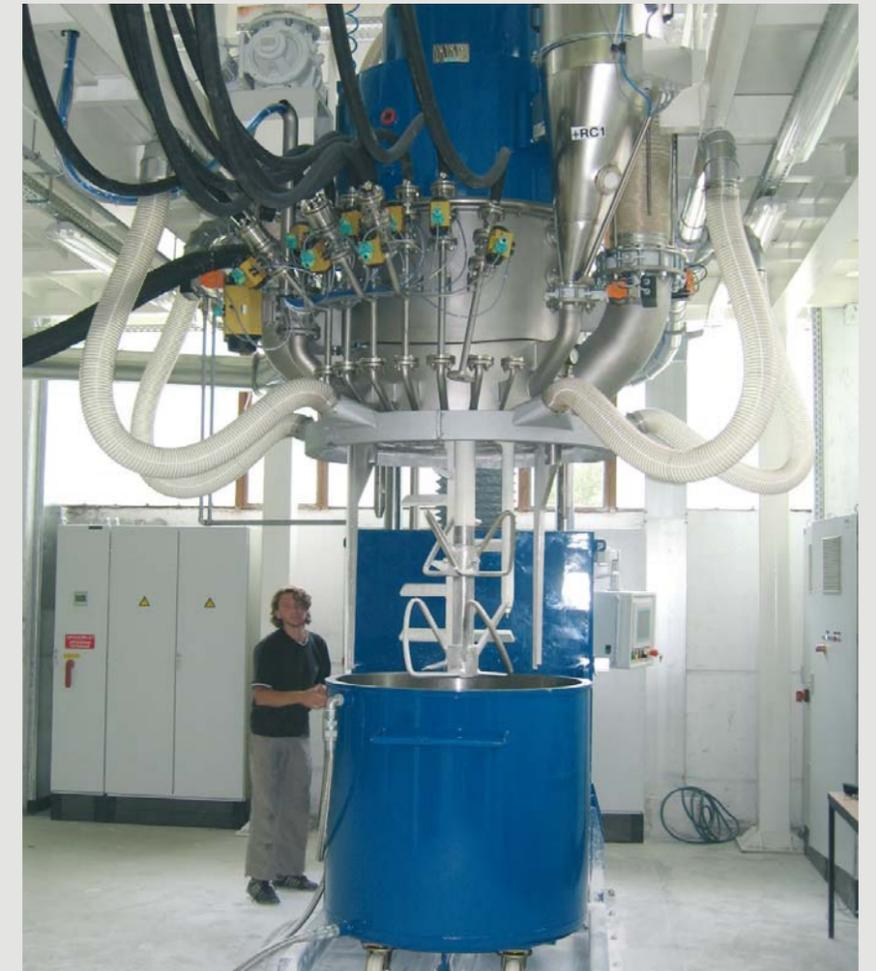
Vollautomatisierte, vakuumdichte Planetenmischer Anlage Typ PMH 1000
