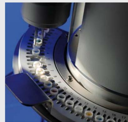
Umfassende Materialanalyse rund um die Uhr mit dem automatischen Probenwechsler
